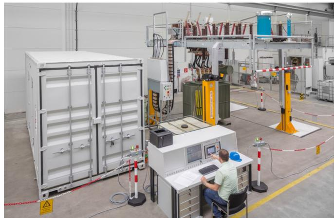
Bild 8. Werksprüfung eines DITAS mit Hebebühne bei HIGHVOLT vor Auslieferung an den Kunden
